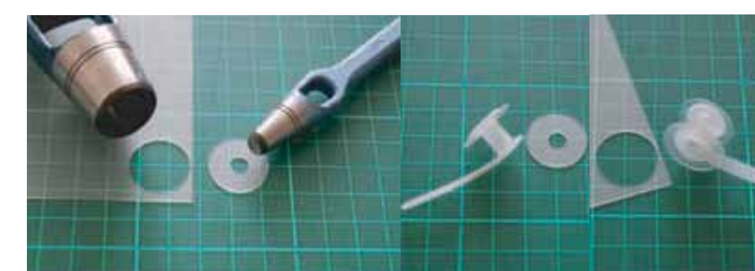
Abb. 8 Herstellung eines dünnen Silikonrings aus 0,3mm dickem implantierbarem Silikon der als vergrößerte trachealer Flansch auf eine Blom-Singer® Large Esophageal Flange Prothese aufgeklebt wird.
